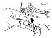
(5) Retirer la partie inférieure du fil de verrouillage du démarreur.
