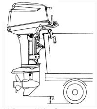
A : la distance au sol doit être suffisante.
