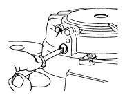
(3) Desserrer la vis du fil de verrouillage du démarreur.
