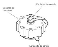
IMPORTANT: Il est possible que le contenu soit sous pression. Dévisser le bouchon de carburant d'un quart de tour, avant de l'ouvrir, afin de libérer la pression.
