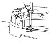
(4) Retirer la partie supérieure du fil de verrouillage du démarreur.
