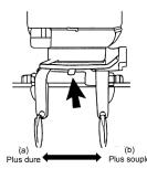
Ajuster cette manette pour obtenir la friction (résistance) souhaitée de la direction sur la barre. Déplacer la manette vers (a) pour durcir la friction et vers (b) pour l'assouplir.
