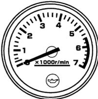
Drehzahlmesser mit Ölleuchte (für P)
