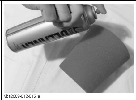
TYPISCH - BESPRÜHEN SIE DAS SCHAUMSTOFFFILTERELEMENT
