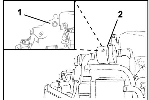
1. Wasserdruckanschluss (hinter Kraftstofffilter) 002166
