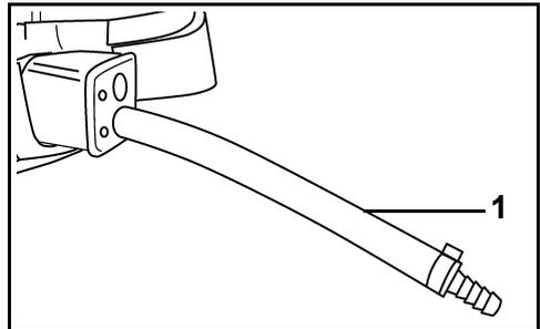
1. Kraftstoffschlauch – 9 mm
