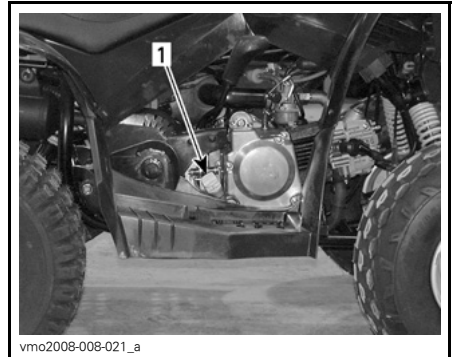
TÍPICO — PARTE DERECHA DEL MOTOR 1. Varilla medidora del nivel de aceite
