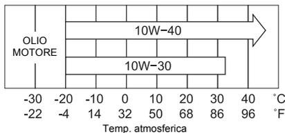
È inoltre possibile utilizzare oli API SF, SG, SH, SJ, SL o SM. Servendosi della tabella in basso, selezionare la viscosità adeguata in funzione della pressione atmosferica.
