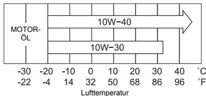
Sie können auch Öle mit der API-Klassifizierung SF, SG, SH, SJ, SL oder SM verwenden. Wählen Sie die richtige Viskosität basierend auf der Umgebungslufttemperatur unter Zuhilfenahme der Tabelle unten.
