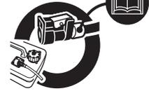
NON utilizzare un gruppo pompetta di adescamento/flessibile privo di dosatore automatico del carburante o di un meccanismo di sigillazione come quello illustrato in basso; può altrimenti verificarsi un traboccamento del sistema di alimentazione o uno spargimento di carburante.
