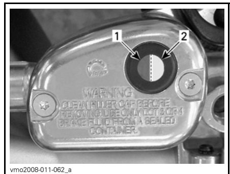
TYPISCH 1. Correct vloeistofpeil 2. Laag vloeistofpeil
