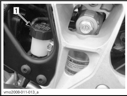
DIT BEVINDT ZICH NAAST HET RECHTERACHTERSPATBORD 1. Achterrem-vloeistofreservoir
