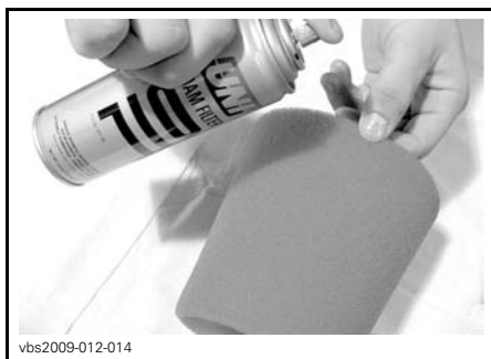
TYPIQUE - HUILER L'ÉLÉMENT EN MOUSSE
