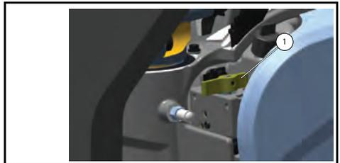
1. Открытое положение, ручной предохранительный клапан для гидравлической системы румпеля с усилителем рулевого механизма
