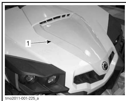
1. Tampa de manutenção
