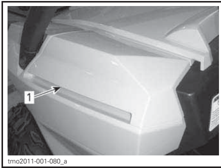
1. Couverture en plastique du filtre à air de la transmission CVC
