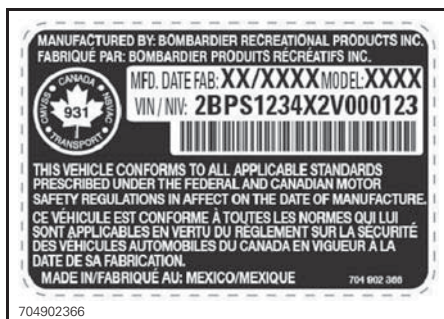
TYPIQUE — AUTOCOLLANT DE NUMÉRO DE SÉRIE DU VÉHICULE SOUS LA BOÎTE À GANTS
