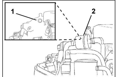
1. Presa per controllo della pressione dell'acqua (dietro al filtro del carburante) 002166 002009
