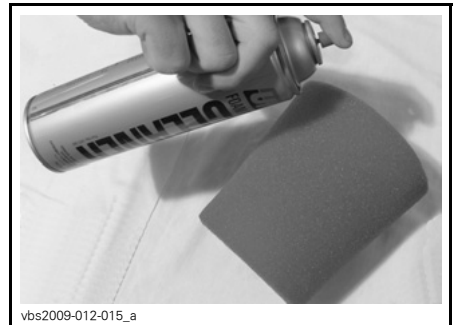
TÍPICO - VAPORIZA O ELEMENTO DE ESPUMA NA PARTE INTERNA E EXTERNA
