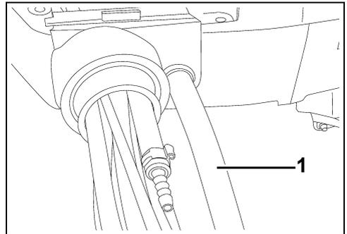
1. Kraftstoffschlauch – 9 mm
