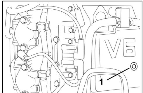
1. Wasserdruckanschluss (hinten)
