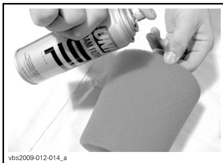
SITUAZIONE TIPICA - OLIO ALL'ELEMENTO FILTRANTE IN MATERIALE ESPANSO
