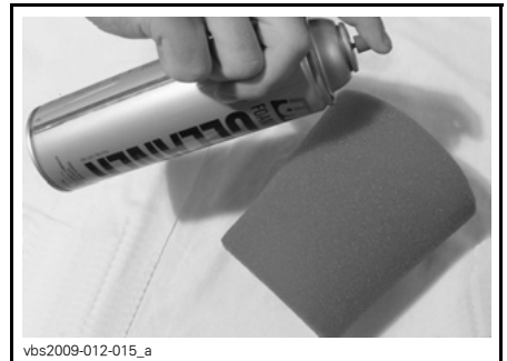
TYYPILLINEN - SUIHKUTA VAAHTOMUOVIPANOS SISÄ- JA ULKOPUOLELTA
