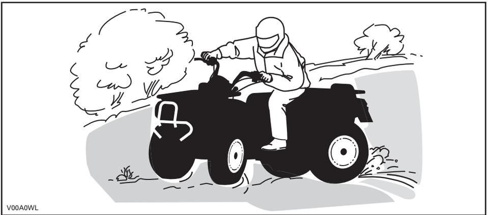
Si el vehículo derrapa o resbala, quizá resulte de utilidad girar el manillar en la dirección del deslizamiento hasta que vuelva a recuperar el control. Procure que no se bloqueen nunca los frenos ni las ruedas.
