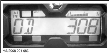
3. Pulse el botón selector y MANTÉNGALO pulsado durante 2 segundos. Con esta acción cambiará el modo de visualización al de velocidad, r.p.m. o combinado.
