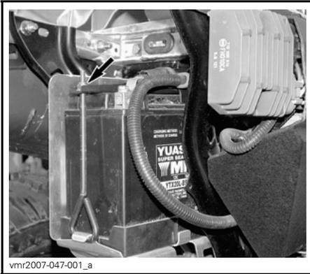
Tire hacia afuera del soporte de la parte superior.
