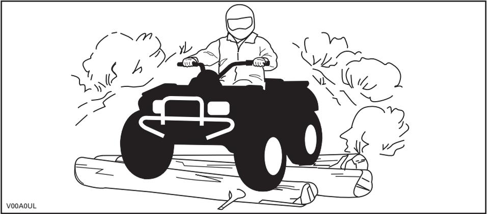
Aunque el vehículo está equipado con un sistema de suspensión adecuado, existen terrenos muy accidentados, llenos de baches, por los que la conducción puede resultar incómoda e incluso dañar la espalda. A menudo será necesario conducir casi en cuclillas. Reduzca la velocidad y flexione las piernas para absorber los impactos.
