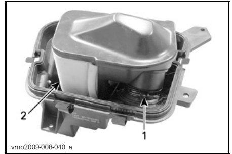
800R EFI-MODELLE 1. Klemme 2. Luftfilter
