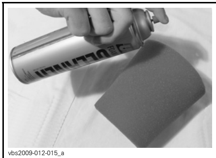
TYPISCH - BESPRÜHEN SIE DAS SCHAUMSTOFFFILTERERELEMENT
