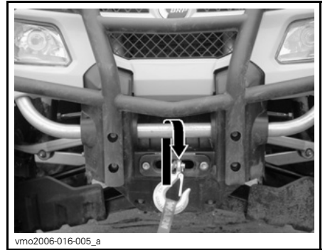
TYPISCH - BEFESTIGUNGSPUNKT VORN
