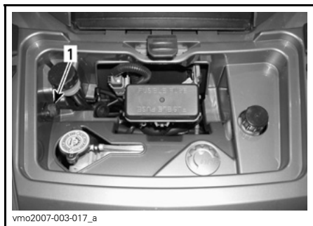
TYPEBILDE SERVICEROM FORAN 1. Tilkobling for fjernkontroll
