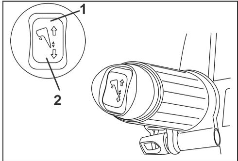
1. Interruptor de elevación/inclinación ARRIBA 005107
