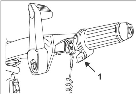
1. Tornillo de fricción del acelerador 005099
