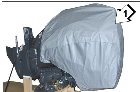
1. Copertura di spedizione
