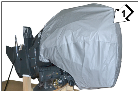
1. Copertura di spedizione
