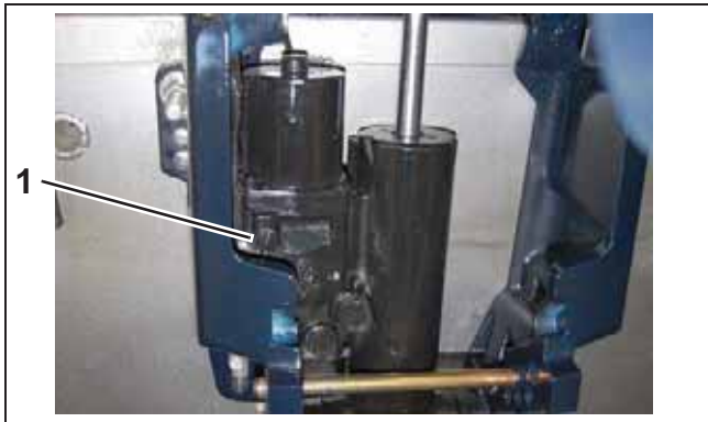
Système à vérin unique, 75–130 cv 1. Bouchon de remplissage
