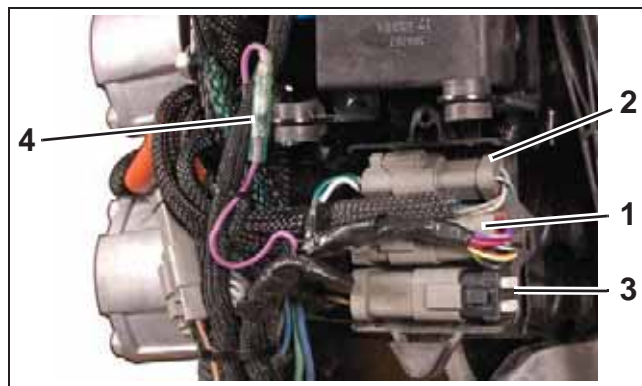
1. Connecteur d'allumage I-Command 2. Connecteur de correction d'assiette/relevage 3. Connecteur SystemCheck (avec joint) 4. Connecteur d'alimentation de réseau (réseaux type Deutsch )
