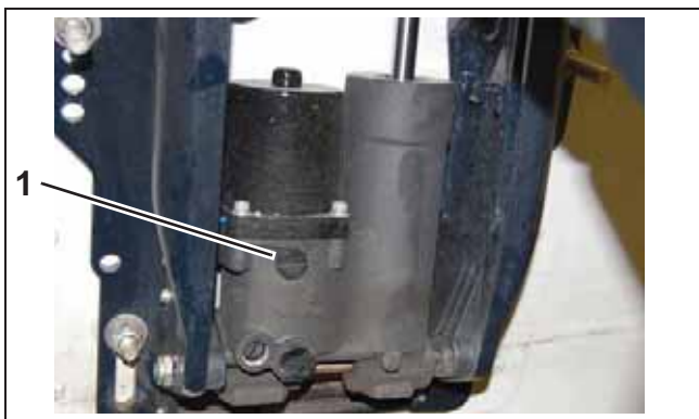
Système à vérin unique, 15–60 cv 1. Bouchon de remplissage
