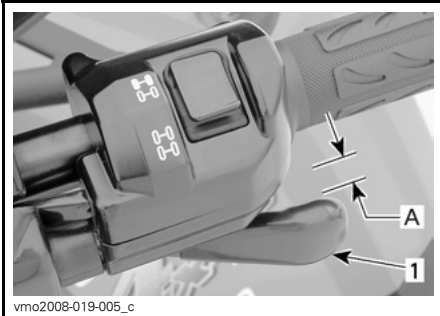
1. Alavanca do acelerador A. 3 mm a 6 mm (1/8 pol a 1/4 pol)
