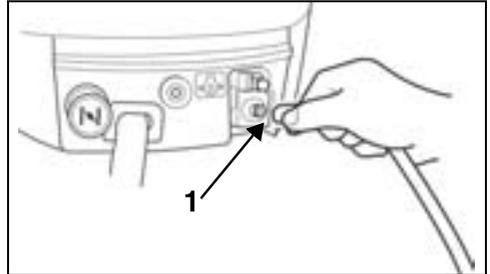
1. Flexible de carburant branché au raccord de carburant
