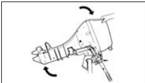
Relever le moteur jusqu'à ce qu'un déclic se fasse entendre et que le moteur reste en position de relevage maximum.
