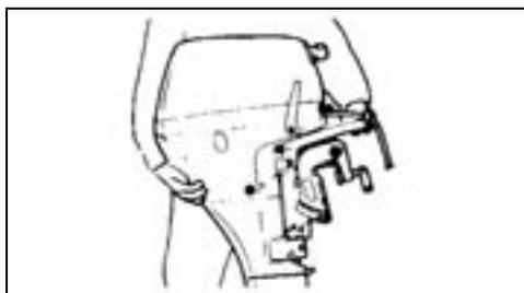
La plaque antiventilation doit alors être entre 0 et 25 mm (0 et 1 po) en dessous de la carène.
