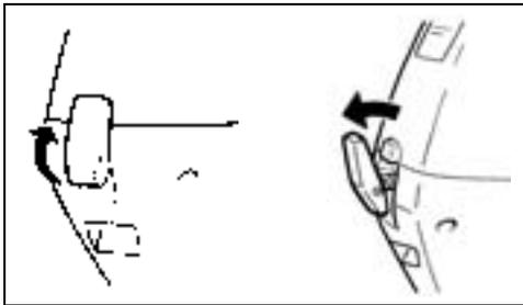
Desserrer l'écrou de blocage. Retirer le câble du support. Séparer l'extrémité du câble de la came.
