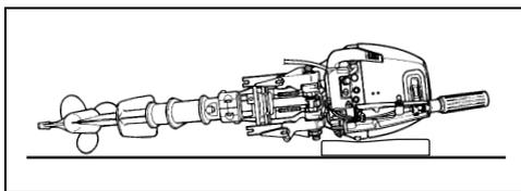
**IMPORTANT** : Ne pas laisser le boîtier d'engrenages du moteur hors-bord reposer plus haut que le bloc-moteur lors du transport ou du remisage. De l'eau risquerait de s'écouler dans le bloc-moteur, ce qui endommagerait le moteur.
