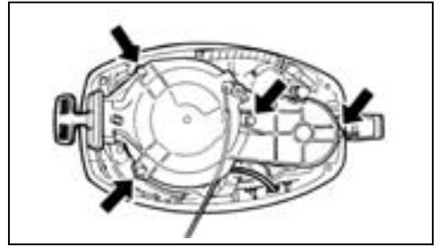
Faire un nœud à l'une des extrémités du cordon de démarrage de secours. Enfiler la petite barre contenue dans la trousse d'outillage à moitié dans l'un des nœuds pour s'en servir comme poignée.
