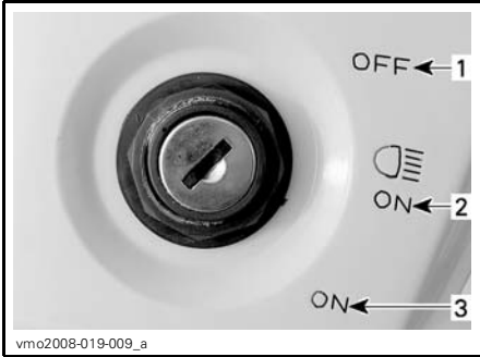
POSITIONS DE L'INTERRUPTEUR D'ALLUMAGE
