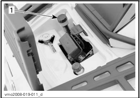
TYPIQUE — COMPARTIMENT D'ENTRETIEN 1. Réservoir
