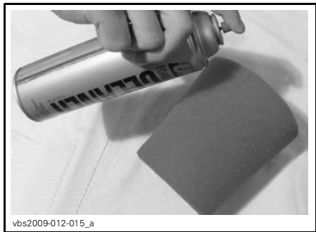
TYPIQUE - IMPRÉGNER L'ÉLÉMENT EN MOUSSE
