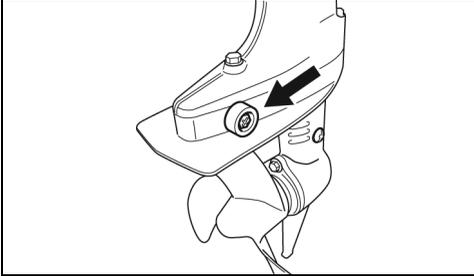
Galvanische Korrosion zerstört Metallteile unter Wasser und kann in Süß- oder Salzwasser auftreten. In Salz-, Brack- und Schmutzwasser wird die Korrosion allerdings beschleunigt.
