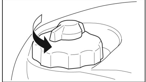
Drehen Sie das Kraftstoffsperrventil nach hinten. Kraftstoff fließt aus dem integrierten Tank.
