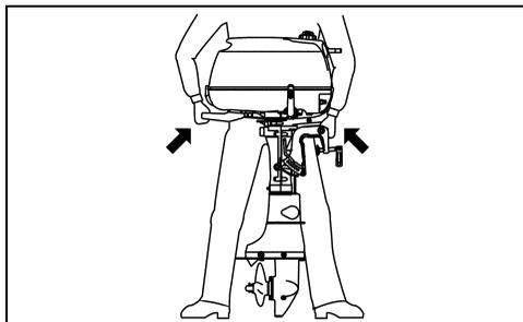
Die sich ergebende Position der Belüftungsschutzplatte muss 0 bis 25 mm (0 bis 1 in.) unterhalb des Bootesbodens liegen.
