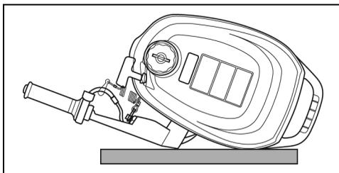
**WICHTIG:** Beim Transport oder bei der Lagerung darf das Getriebe des Außenborders nicht höher als der Motorkopf liegen. Dadurch kann Wasser in den Motorkopf gelangen und einen Motorschaden verursachen.
