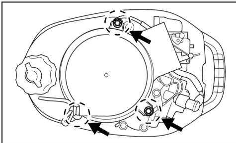
Heben Sie die Rückschnell-Starter-Einheit ab.
