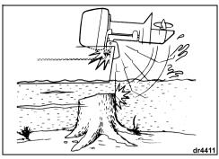
Das Stoßdämpferystem des Motors funktioniert nicht im Rückwärtsgang. Wenn Sie rückwärts gegen ein Objekt fahren - entweder im Wasser oder beim Transport - können Boot und Motor schwer beschädigt werden.
