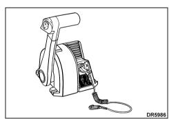
WICHTIG: Beim Schalten vom VORWÄRTSGANG in den RÜCKWÄRTSGANG oder vom RÜCKWÄRTSGANG in den VORWÄRTSGANG warten Sie in NEUTRAL-Position, bis der Motor Leerlaufdrehzahl erreicht hat und das Boot langsamer geworden ist.
