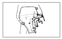
Die sich ergebende Position der Belüftungsschutzplatte muss 0 bis 25 mm (0 bis 1 in.) unterhalb des Bootesbodens liegen.
