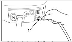
Kraftstoffschlauch an Kraftstoffanschluss
