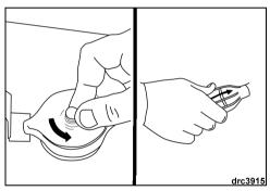
Befestigen Sie die Notstoppklemme am Notstopp-/Zündschalter. Befestigen Sie die Leine an einer **sicheren** Stelle der Kleidung des Fahrers oder der Schwimmweste, von der sie sich nicht losreißen kann, statt den Stoppschalter zu aktivieren.
