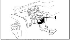
1. Kippsperrhebel in RELEASE-Position
