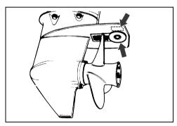
Galvanische Korrosion zerstört Metallteile unter Wasser und kann in Süß- oder Salzwasser auftreten. In Salz-, Brack- und Schmutzwasser wird die Korrosion allerdings beschleunigt.
