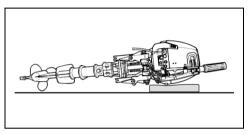
**WICHTIG:** Beim Transport oder bei der Lagerung darf das Getriebe des Außenborders nicht höher als der Motorkopf liegen. Dadurch kann Wasser in den Motorkopf gelangen und einen Motorschaden verursachen.
