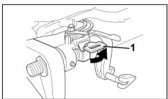
Kippsperrhebel in RELEASE-Position
