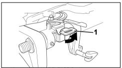
1. Kippsperrhebel in RELEASE-Position
