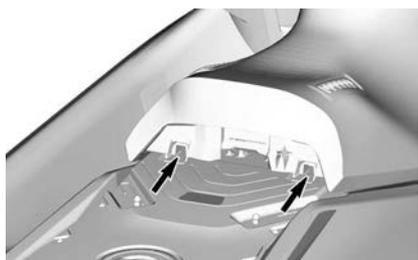
3. Allineare i fermi dell'estremità posteriore del sedile con i perni di aggancio e premere saldamente verso il basso l'estremità posteriore del sedile per bloccarla in posizione.
