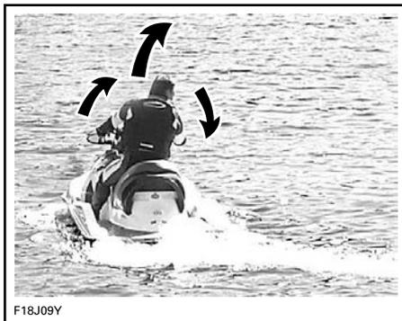
Girando il manubrio, l'iniettore della pompa a getto che controlla la direzione dell'imbarcazione gira su sé stesso. Girando il manubrio a destra, l'imbarcazione vira a destra e viceversa. È necessario premere l'acceleratore per sterzare.
