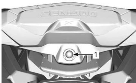
Per consentire al motore di avviarsi, il cappuccio del cordoncino di sicurezza deve essere saldamente fissato all'interruttore di spegnimento del motore.
