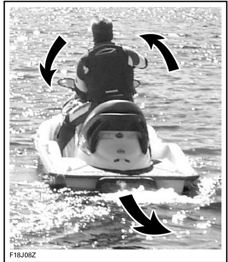
TYPISCH - LENKRICHTUNG BEIM ZURÜCKSETZEN UMGEKEHRT
