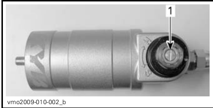
1. Dispositif de réglage de la compression à basse vitesse (tournevis plat)
