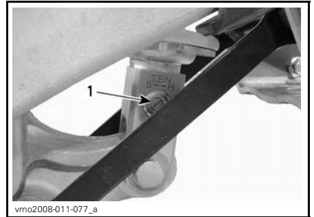
1. Dispositif de réglage du rebond (tournevis à lame plate)
