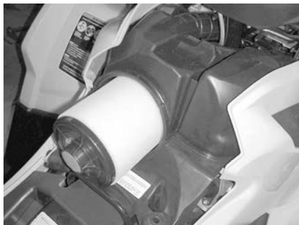
RIMOZIONE DEL FILTRO DELL'ARIA
