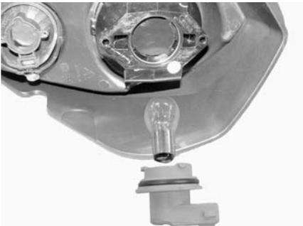
4. Извлеките патрон лампы из корпуса заднего фонаря.
