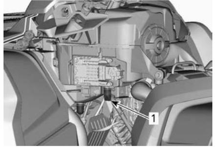
1. Впускная дренажная трубка корпуса воздушного фильтра.
