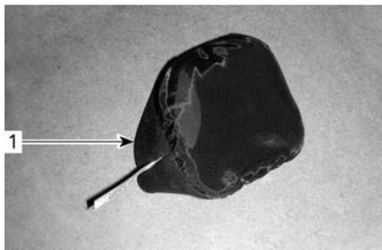
1. Воздушный фильтр вариатора со скользящим соединением
