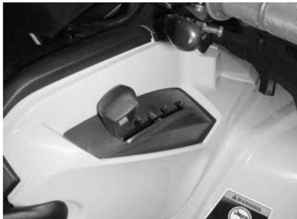
**РАСПОЛОЖЕНИЕ РЫЧАГА ПЕРЕКЛЮЧЕНИЯ ПЕРЕДАЧ**
