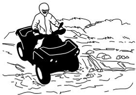
Мокрые тормоза негативно повлияют на возможности тормозной системы. После движения по воде, грязи или снегу обязательно несколько раз приведите в действия тормоза, для того чтобы просушить их. Оставляйте больше места для торможения.
