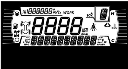
Отображает положение передач:
