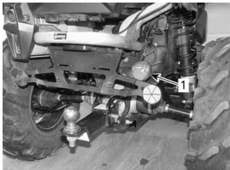
1. Разъем для подключения электрооборудования прицепа
