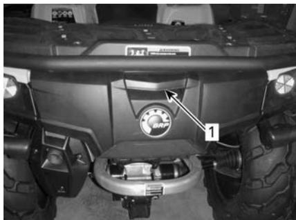
1. Крышка заднего багажного отсека
