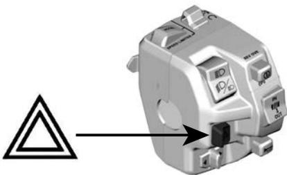
Нажмите кнопку сбоку, чтобы включить аварийную световую сигнализацию. Для выключения нажмите кнопку с другой стороны.
