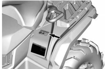
**Давление в шинах и максимальная нагрузка – предупреждающая пиктограмма**
