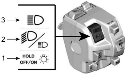
1. Регулировка света / свет ВЫКЛ.
