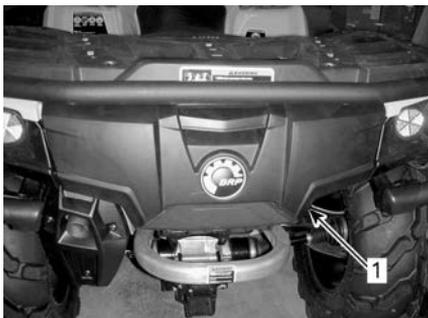
1. Крышка заднего багажного отсека
