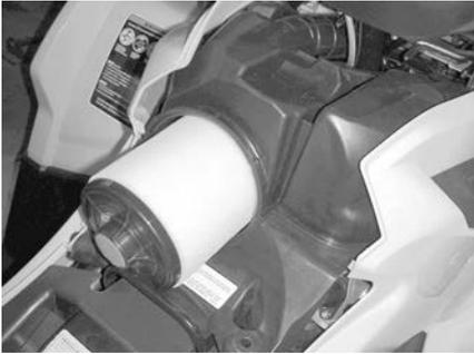
**Осмотр и опорожнение корпуса воздушного фильтра двигателя**
