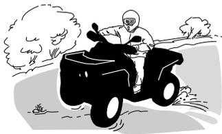
В случае, если вы попали в скольжение или занос, поворот руля в сторону заноса может помочь вам вернуть управление мотовездеходом. Ни в коем случае не блокируйте тормоза и колеса.
