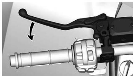
Сила торможения пропорциональна силе нажатия на рычаг.
