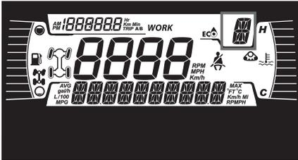
Diese Anzeige zeigt die Getriebestellung an:
