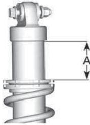
A = FEDERVORSPANNUNG-DISTANZ
