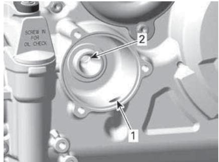
1. Einlass-Bohrung der Ölpumpe zum Ölfilter
