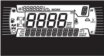
Anzeige der Fahrzeuggeschwindigkeit in km/h oder MPH.
