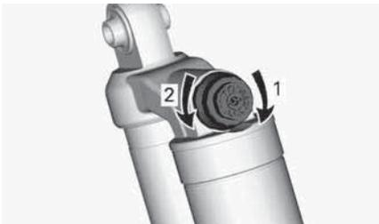
**DRUCKSTUFENDÄMPFUNG - OBEN AM STOßDÄMPFER**
