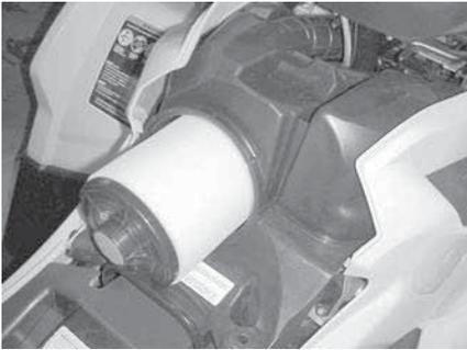
**Untersuchen und Entleeren des Motorluftfilterkastens**
