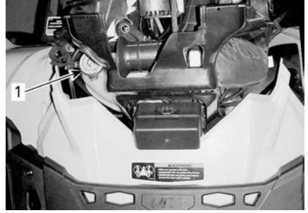
1. Réservoir du liquide de refroidissement
