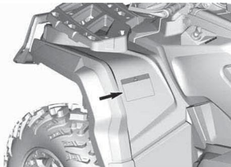
**Pressione pneumatici e carico massimo - Pittogramma di avvertenza**
