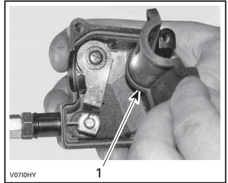
1. Protezione interna dell'alloggiamento
