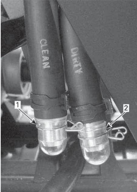
1. Pulire il serbatoio di scarico sotto l'alloggiamento del filtro dell'aria
