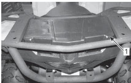
1. Dispositivo di chiusura del vano bagagli posteriore
