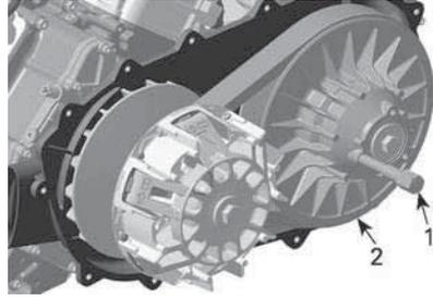
1. *Strumento di traino/bloccaggio*
