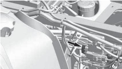
Il portafusibili del DPS è collocato nella parte posteriore del pannello laterale destro.
