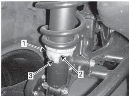
**CONFIGURAZIONE TIPICA – AMMORTIZZATORE CON CAMMA DI REGOLAZIONE**
