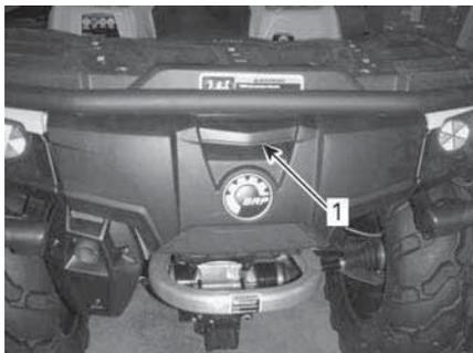
1. Dispositivo di chiusura del vano bagagli posteriore
