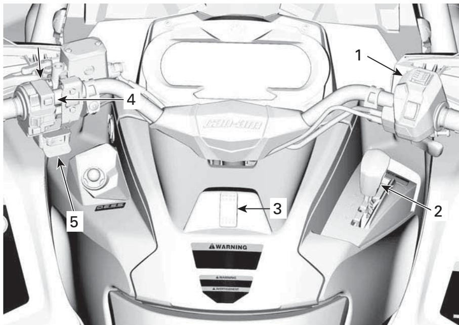
1. Alloggiamento del comando della leva dell'acceleratore
