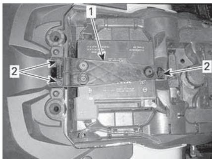
1. Fascetta di fissaggio della batteria
