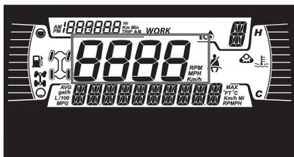
Visualizza la velocità del veicolo in km/h o in MPH.
