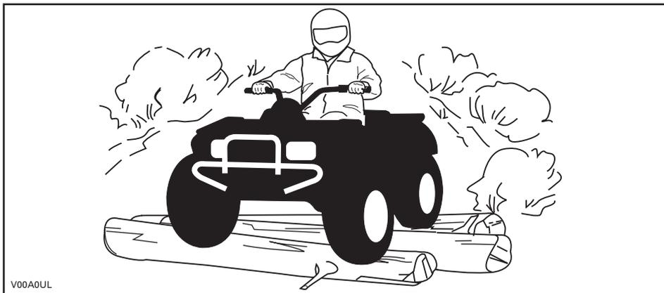
Embora o veículo tenha um bom sistema de suspensão, há situações de terrenos acidentados ou “ondulações” que podem causar desconforto e até mesmo ferimentos nas costas. É muitas vezes necessário viajar ou “dirigir” em uma posição encolhida. Reduza a velocidade e deixe que as pernas flexionadas absorvam o impacto.
