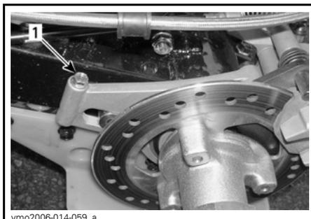
1. Parafuso do suporte do calibrador
