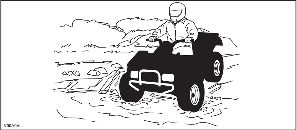
A água afeta a capacidade de freagem do veículo. Seque os freios, freando várias vezes depois de sair da água.
