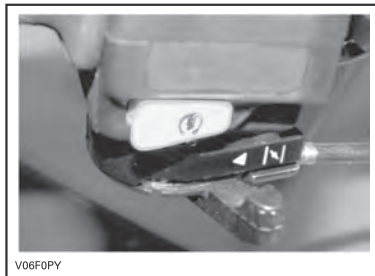
РУКОЯТКА ВОЗДУШНОЙ ЗАСЛОНКИ В ПОЛОЖЕНИИ «OFF»
