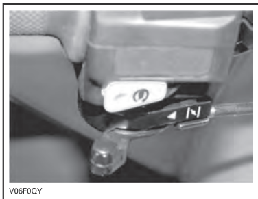
ПОЛОЖЕНИЕ РУКОЯТКИ ВОЗДУШНОЙ ЗАСЛОНКИ «FULL»
