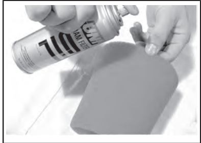
ТИПОВОЙ ВАРИАНТ — НАНЕСЕНИЕ МАСЛА НА ПОРОЛОНОВЫЙ ФИЛЬТРУЮЩИЙ ЭЛЕМЕНТ
