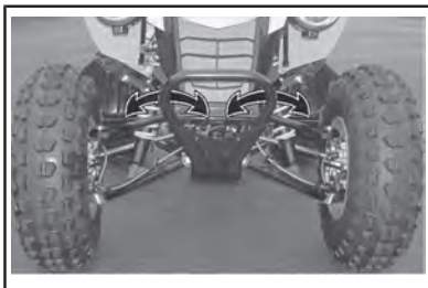
МЕСТА КРЕПЛЕНИЯ РЕМНЕЙ НА ПЕРЕД- НЕМ БАМПЕРЕ
