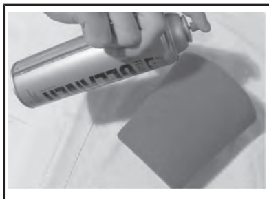
TYPIQUE – VAPORISER DU NETTOYEUR À L'INTÉRIEUR ET À L'EXTÉRIEUR DU FILTRE EN MOUSSE
