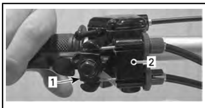
1. Argola do cabo 2. Suporte do cabo
