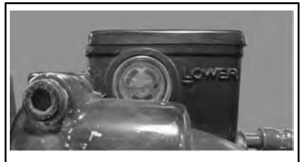
DEPÓSITO DE LÍQUIDO DE FRENOS DE LA PARTE TRASERA, EN EL LADO IZQUIERDO
