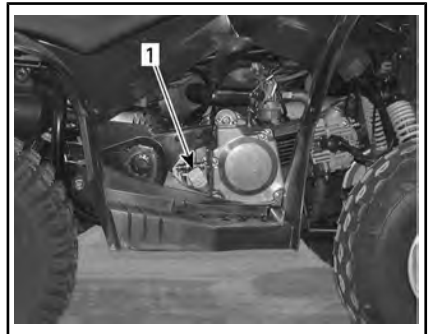
TÍPICO — LADO DERECHO DEL MOTOR 1. Varilla medidora del nivel de aceite
