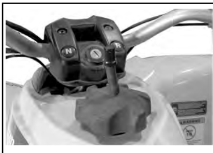
TÍPICO — TAPÓN DEL DEPÓSITO DE COMBUSTIBLE
