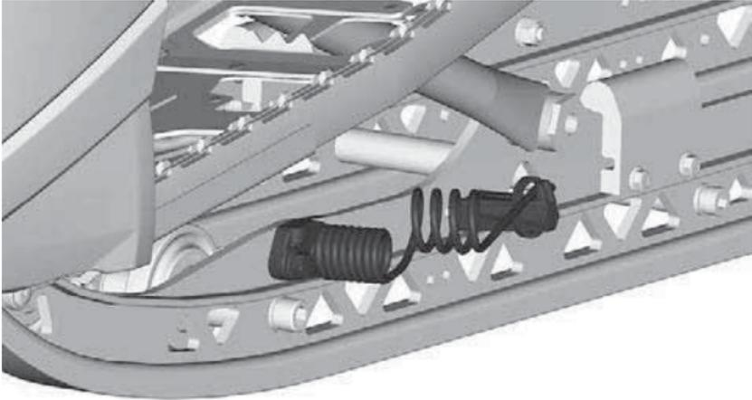
Eiskratzer müssen immer verwendet werden, wenn das Fahrzeug auf Pisten, festgefahrenem Schnee oder Eis eingesetzt wird.
