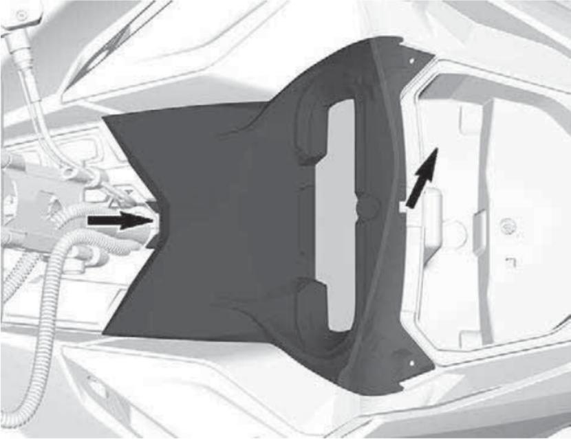
5. Klemmen Sie den Steckverbinder des Anzeiginstruments ab und entfernen Sie die Halterung.
