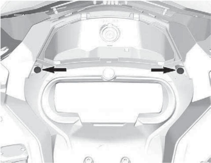
4. Heben Sie die Vorderseite der Anzeigeeinstrumentshalterung an und schieben Sie diese anschließend nach vorne, um sie abzunehmen.
