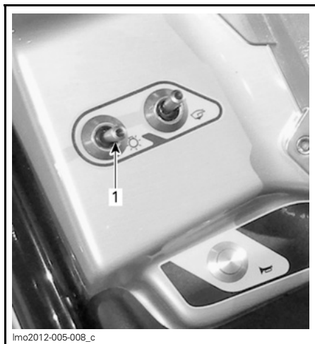
1. Interruptor das luzes de navegação
