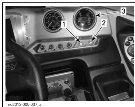
TÍPICO 1. Para motor de bombordo 2. Para motor de estibordo 3. Indicador analógico de combustível
