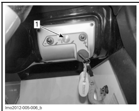
1. Interruptor do sistema sem algas
