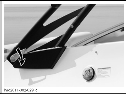
DRAAI DE HENDEL 3/4 SLAG WIJZERZIN (STUURBOORDZIJDE)
