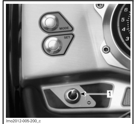
1. OMHOOG- en OMLAAG-schakelaar
