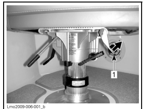
STUURZETEL 230 WAKE EN 230 CHALLENGER SE 1. Hendel
