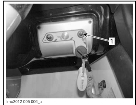
1. Bilge blower switch
