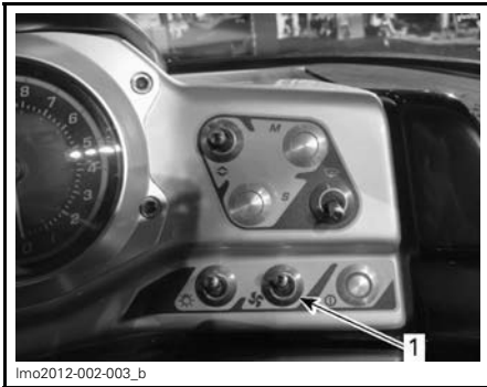
1. Bilge blower switch
